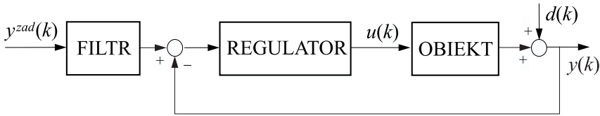
Rysunek 3.82. Klasyczny układ regulacji o dwóch stopniach swobody
