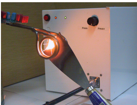
Nagrzewnica indukcyjna (praca magisterska IR PW)
