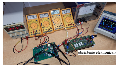
Pomiary przetwornicy laboratoryjnej z wykonanym z transformatorem
